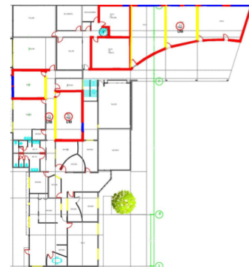
Fig. 1. Plano de la planta baja de la Facultad de Artes y Comunicación mostrando la distribución de los AP actuales.
