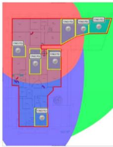
Fig. 10. Mapa de calor en Planta Baja de los Access Points hecha en Aruba VisualRF Plan.
