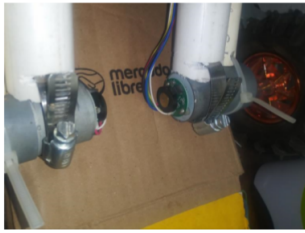
Figura 24. Colocación de los motores con sus llantas en las estructuras del robot.
