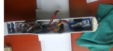
Figura 65. Acomodo y fijación de los componentes electrónicos con su distribución de peso.
