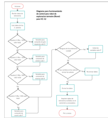
Figura 18. Diagrama de flujo del programa para el funcionamiento del robot terrestre.
