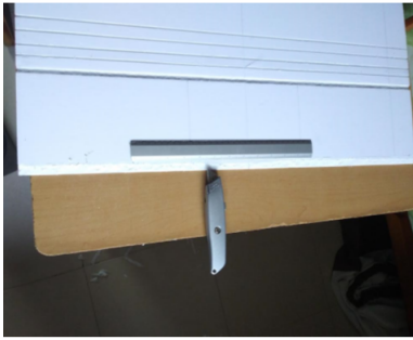
Figura 36. Corte inclinado para pegar la estructura curvada del ala
