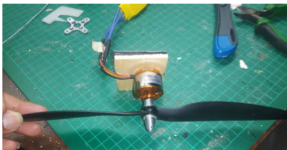
Figura 53. Fijación del motor en la base que será pegada en la estructura del drone.
