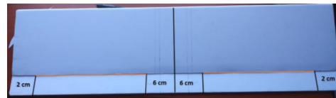
Figura 41. Muestra las medidas para cortes de alerones en negro e incisión o corte no profundo en color naranja
