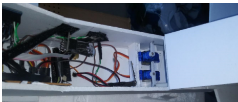
Figura 60. Ubicación y colocación de los servos utilizados para los timones en la parte trasera del avión.
