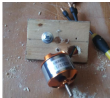
Figura 52. Colocación del motor brushless
