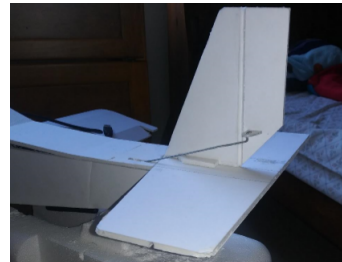
Figura 56. Seguro para alambre en timón vertical
