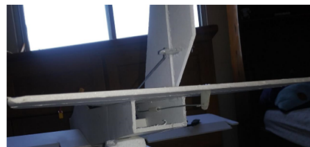
Figura 57. Seguro para alambre en timón vertical
